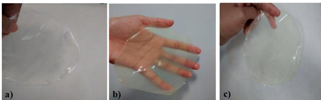
Figura 1: Filmes de amido incorporados com 0, 30 e 60g de extrato etanólico de própolis 100g<sup>-1</sup> de amido (a)  $C_{EEP} = 0$  100g<sup>-1</sup> g de amido; (B)  $C_{EEP} = 30$  g 100g<sup>-1</sup> de amido; (C)  $C_{EEP} = 60$  g 100g<sup>-1</sup> de amido.
